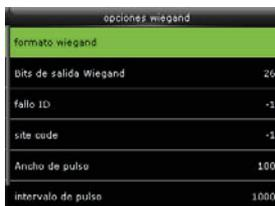
Presione ▲ / ▼ Y OK para seleccionar elementos. Cuando se haya completado la configuración, pulse Aceptar para guardar la configuración y salir
