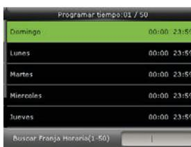
Utilice las teclas numéricas para buscar un horario en el intervalo de 1 a 50. Presione ▼ para seleccionar el elemento que desea ajustar y presione OK.
