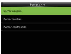
Pulse ▼ para seleccionar el elemento a borrar y pulse OK
