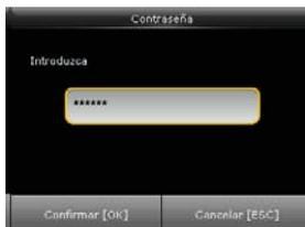
introduzca una contraseña utilizando el teclado y pulse OK. La terminal FFR es compatible con las contraseñas de 1 a 8 dígitos por defecto
