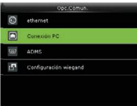
Utilice la tecla ▼ Elija "Conexión con el PC" y presione OK.
