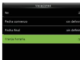
Presione ▼ para seleccionar un horario y pulse OK.
