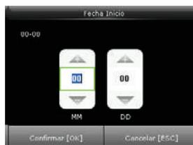
Presione ◀/▶ para seleccionar una opción de tiempo y presione ▲/▼ para ajustar la fecha. Después de establecer una fecha, pulse Aceptar para guardar la configuración y salir
