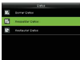
Presione ▼ para seleccionar respaldar datos y pulse OK
