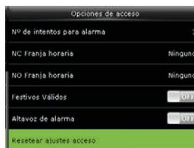
Presione ▲ / ▼ para mover el cursor hasta el elemento que desea ajustar. Si es el cuadro de entrada, pulse las teclas numéricas para introducir el valor. Si se trata de la caja de selección, pulse ◀ / ▶ para cambiar el valor. Después de la configuración, pulse Menú directamente para volver a la última interfaz. Pulse la tecla "ESC" para cancelar el ajuste y volver a la última interfaz.
