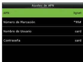
**APN:** Access Point Name, que se utiliza para identificar los tipos de red GPRS/WCDMA.
