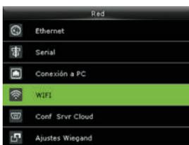
Presione ▼ para seleccionar la red inalámbrica y pulse OK
