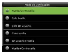
Presione ▲/▼ para seleccionar el modo de verificación, presione OK para guardar y salir.
