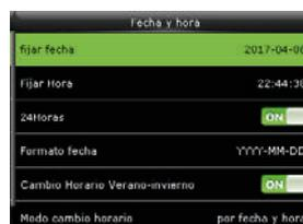
.Presione ▲ / ▼ y OK para seleccionar las opciones. Cuando el ajuste es completado, pulse Aceptar para guardar la configuración y salir.
