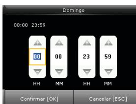
Presione ◀/▶ para seleccionar una opción de tiempo y presione ▲/▼ para ajustar la hora. Después de establecer un período de tiempo, pulse Aceptar para guardar la configuración y salir
