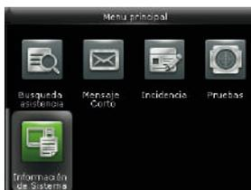
Presione ► para seleccionar la información del sistema y pulse OK.
