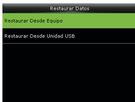
Presione ▼ Para seleccionar respaldar desde equipo y pulse OK.
