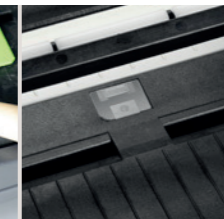
> sensor transmisivo fijo central
